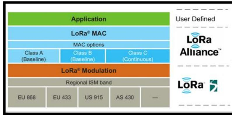
Fig. 1. Protocolo de comunicación y la arquitectura del sistema de LoRaWAN [2]
