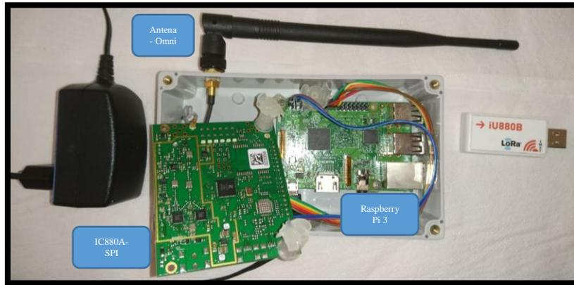
Fig. 4. Pasarela LoRaWAN y módulo USB iU880B
