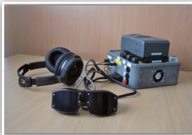
Figura 2. Imagen real con los elementos del sistema: gafas (elemento sensor), auriculares y FPGA.
