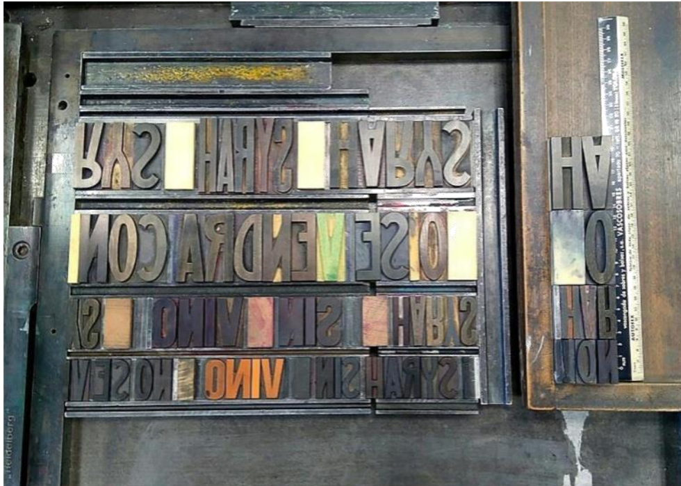
Imagen 54. Composición de tipos móviles de madera en la rama
