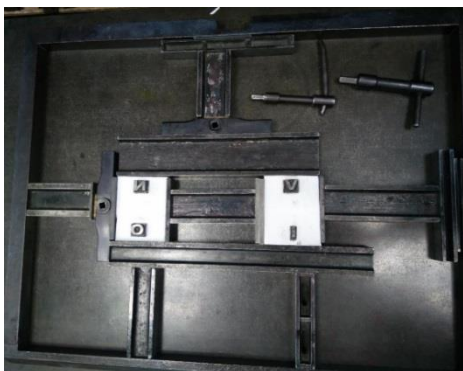
Imagen 53. Fotos de la composición de la rama y la respectiva estampa correspondiendo al pliego que queda en la parte interior.
