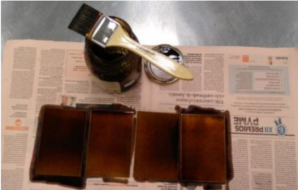
Imagen 42. Aplicación de barniz en plancha.
