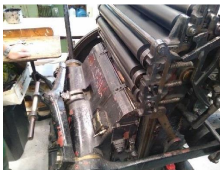
Imagen 70. Imprenta Minerva modelo Hispania y de secadero con todas las estampas recién salidas de la Minerva.
