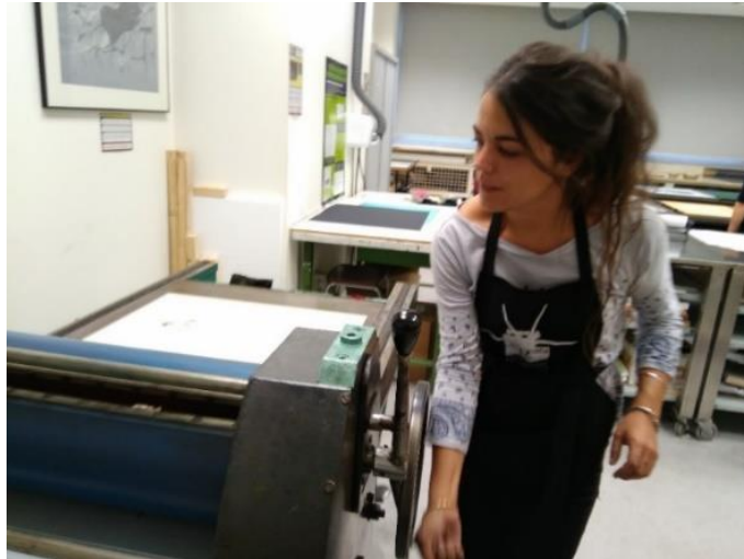
Imagen 89. Inicio del paso de la Plancha de Offset por el tórculo
