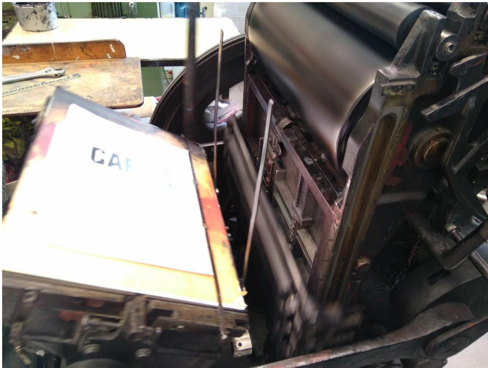
Imagen 61. Impresas las portadas en imprenta Minerva modelo Hispania.
