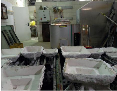
Fig. 41. Montaje piezas para la colada.
