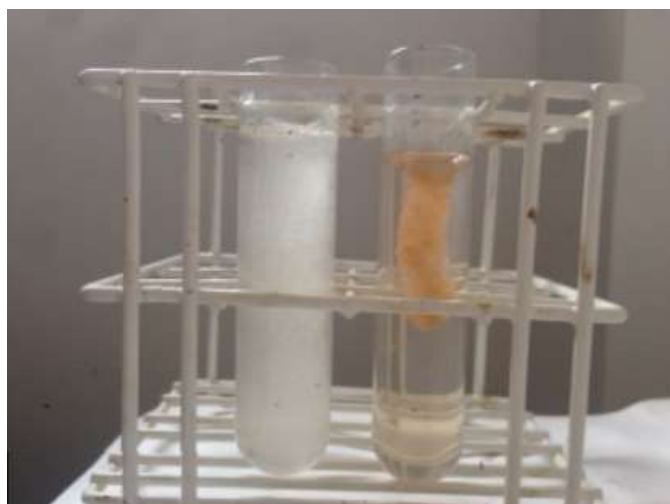
Figura 2. Muestra antes del Jar-Test (izquierda). Muestra tras el Jar-Test (derecha)
