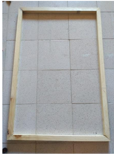
Fig. 20. Bastidor ya encolado
