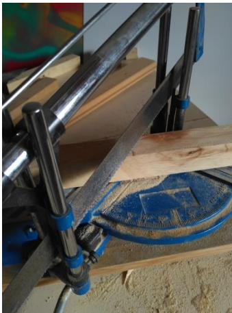
Fig. 17. Ingletadora manual utilizada para la elaboración de los soportes.
