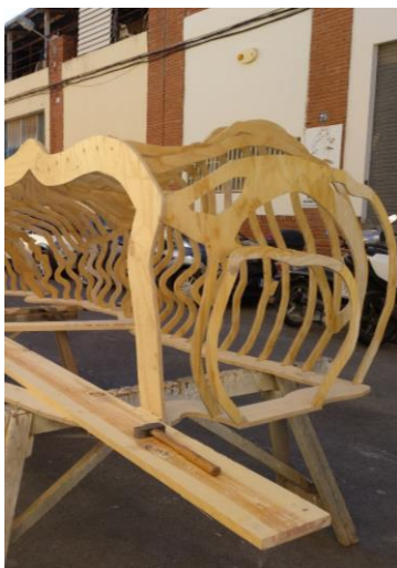
16. Entramado de dogas y costillas que conforman el volumen.
