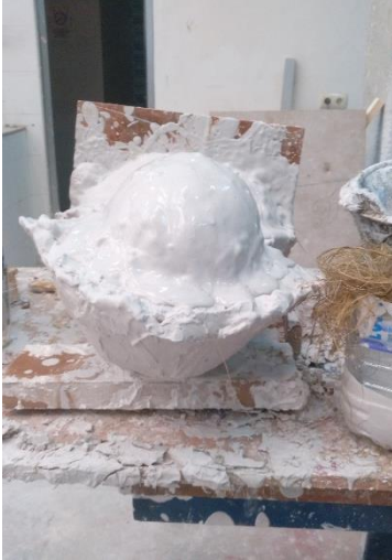
41. Producción de la parte posterior del molde.
