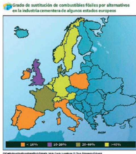
Figura 14. Grado de sustitución de combustibles fósiles por combustibles alternativos en la industria cementera europea, año 2008.
