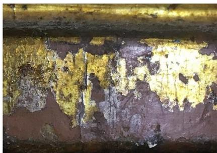
Figura 61. Fotografía detalle oxidación de la plata.
