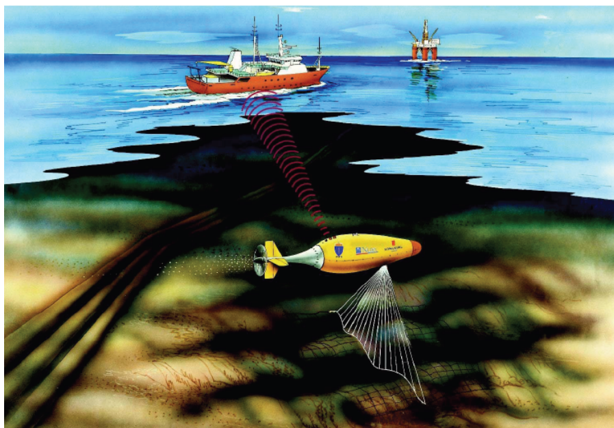
Figura 1.5: Robot AUV explorando el terreno mediante un sensor multihaz o multibeam sensor.
