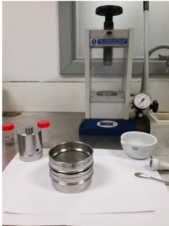
Figura 14. Equipo para pastillar formado por una prensa hidráulica, un troquel, mortero y maza y varios tamices de la luz de malla requerida.
