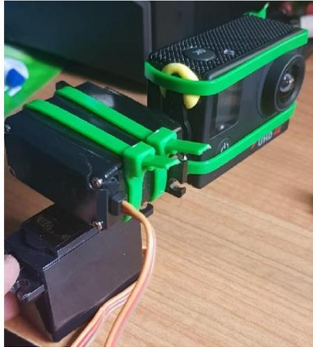
**Ilustración 18: montaje de servomotores y cámara**
