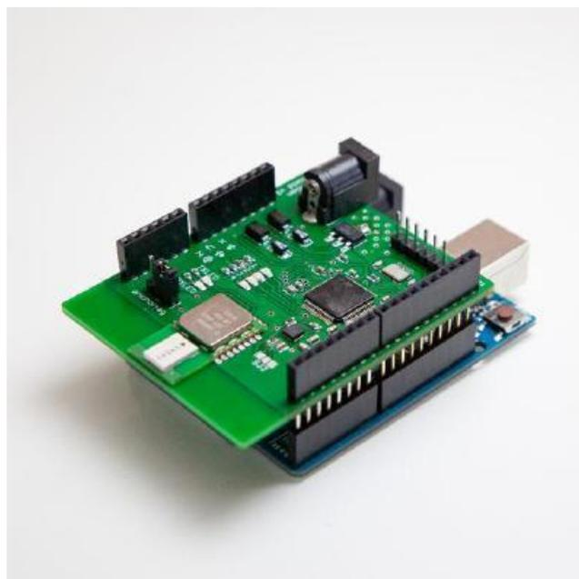
**Ilustración 17: *tag* montado sobre placa Arduino Uno [2]**
