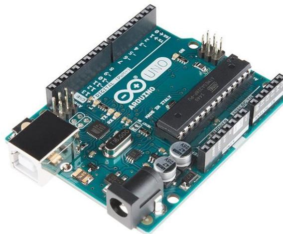
**Ilustración 8: placa Arduino [10]**
