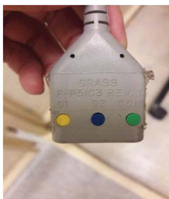
**Figura 12: Entrada con tres terminales del amplificador.**
