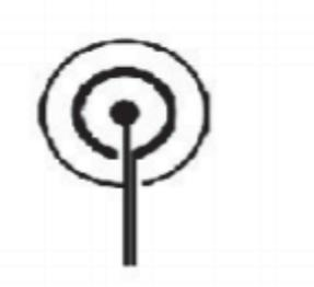
**Figura 7: Configuración del electrodo bipolar concéntrico. Obtenido en (Zena, 2017).**
