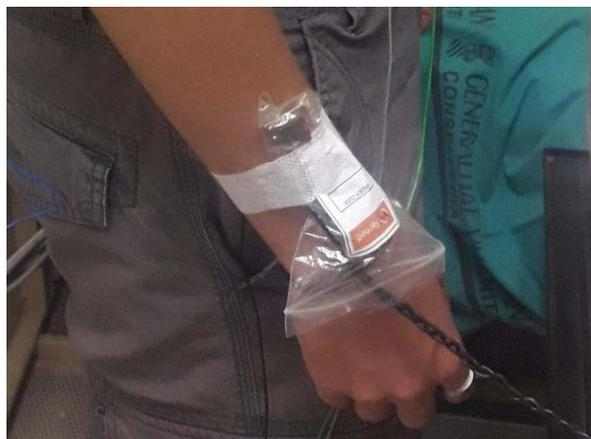
**Figura 20: Localización del acelerómetro triaxial.**
