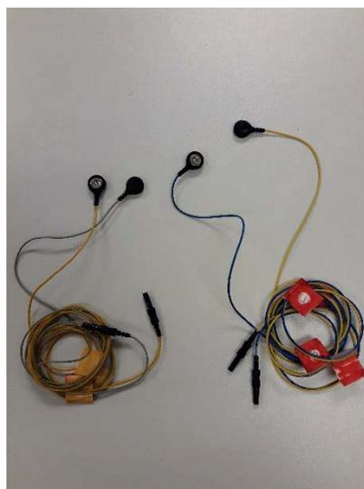
**Figura 8: Electrodos monopolares y cables para la conexión de los electrodos al sistema de adquisición.**
