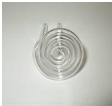
Imagen 2. Celda utilizada para la detección quimioluminescente.
