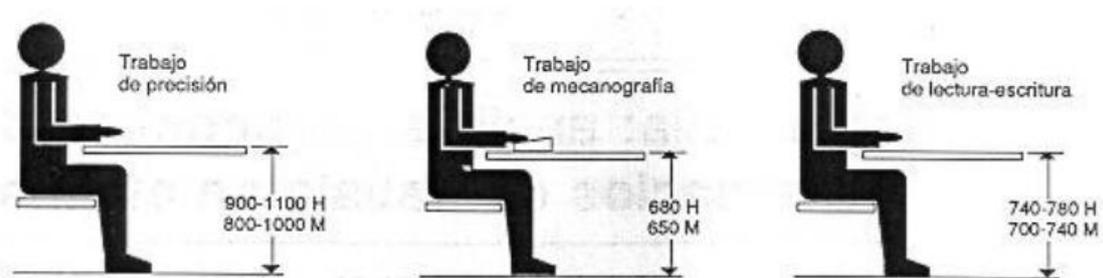
*Figura 13. Altura del plano de trabajo para puestos de trabajo sentado (cotas en mm). Fuente: NTP 242 del INSHT.*
