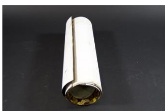
Imágenes 26 y 27. Láminas enrolladas. Pérdida de planimetría.
