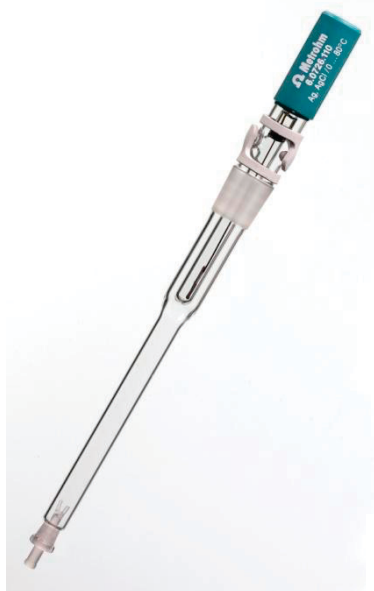
Figura 3.4. Electrodo de referencia de Ag/AgCl modelo 6.0726.110 de Metrohm
