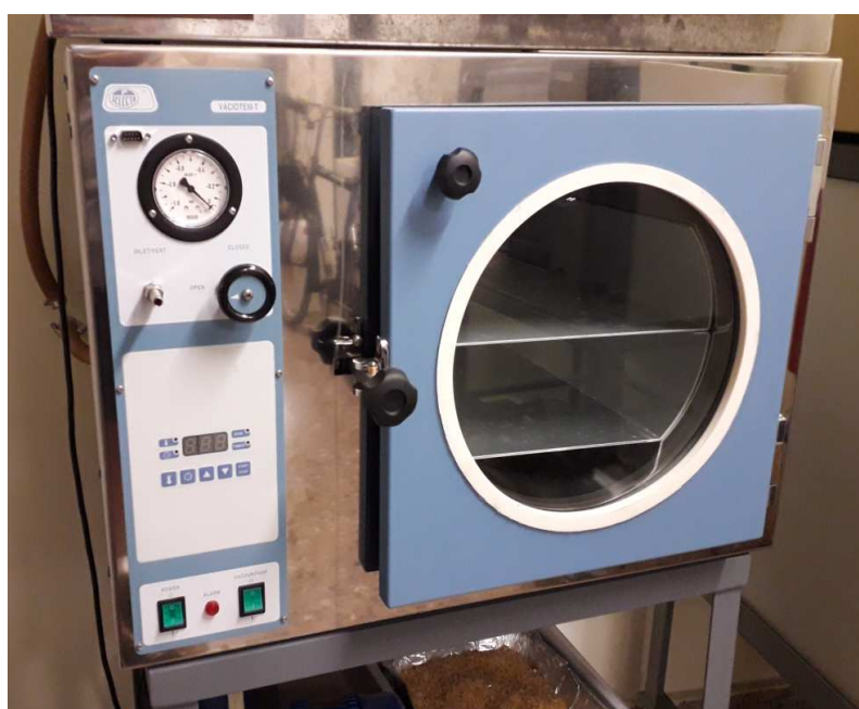
Figura 3.3. Estufa usada para la determinación del contenido de humedad de las muestras.
