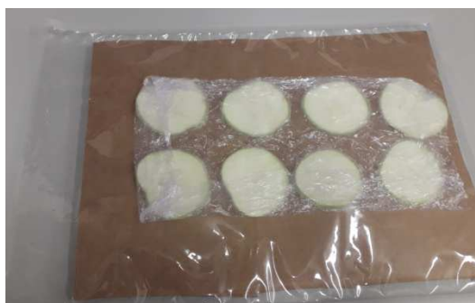
Figura 3.2. Muestras envueltas en papel del film y cubiertas con un plástico para evitar pérdidas de humedad.
