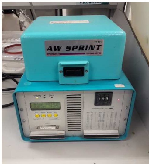
Figura 3.4. Equipo usado para la determinación de la a_w de las muestras después del secado.
