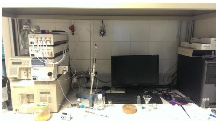
**Imagen 2. Equipo de cromatografía líquida de alta resolución (HPLC)**
