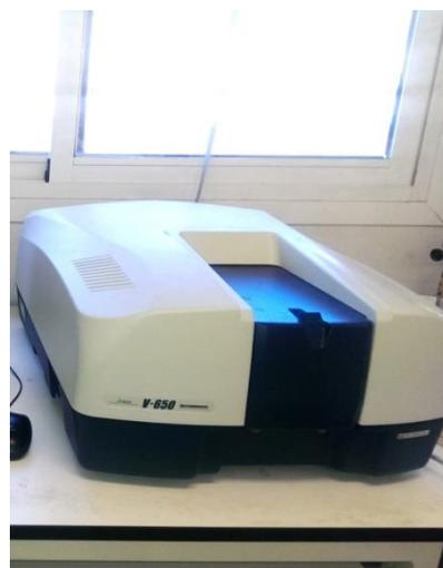
**Imagen 3. Espectrofotómetro JASCO V-650**
