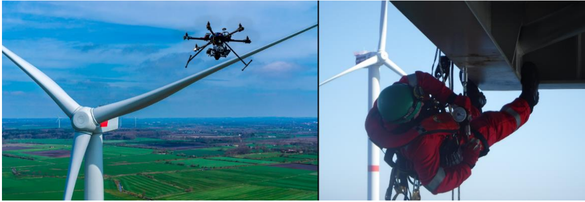
Figura 15. Comparación riesgo mantenimiento con drones y humano. Fuente: ajustado de http://www.offshoreinspections.co.uk/what-are-the-difficulties-of-wind-turbine-maintenance-and-inspections-b45
