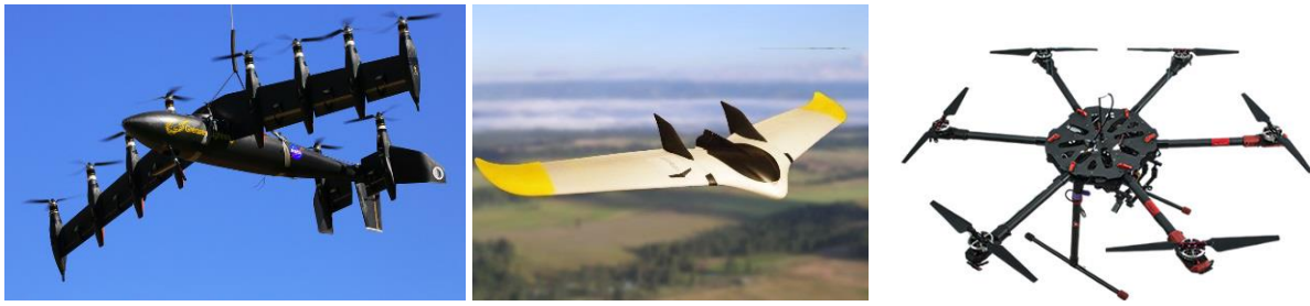
Figura 6. Tipología RPAS, de izquierda a derecha: híbrido, de ala fija y ala rotatoria. Fuente: https://dronerative.com/
