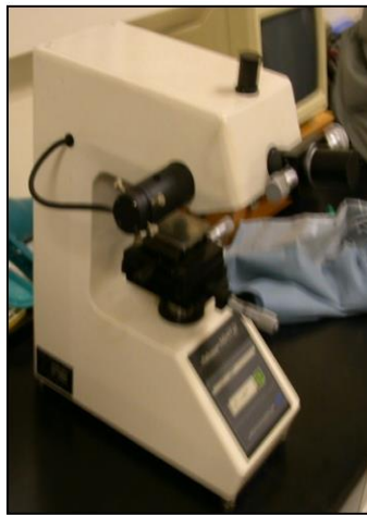
Ilustración 23. Microdurómetro INNOVATEST para realizar durezas en este trabajo
