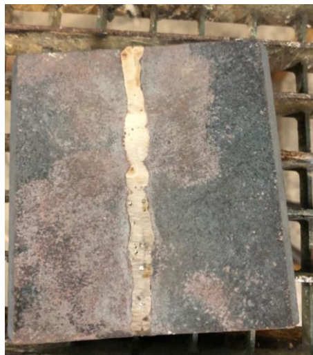
Ilustración 33. Cordón de soldadura terminado para muestra sometida a un recocido
