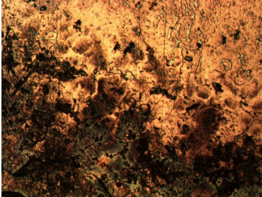
Ilustración 30. Material de aporte e interfase muestra con precalentamiento
