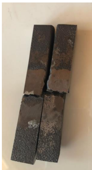
Ilustración 21. Probetas de ensayo de tracción para material sin tratamiento térmico
