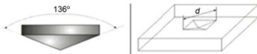
Ilustración 14. Geometría del punzón para determinación de durezas Vickers
