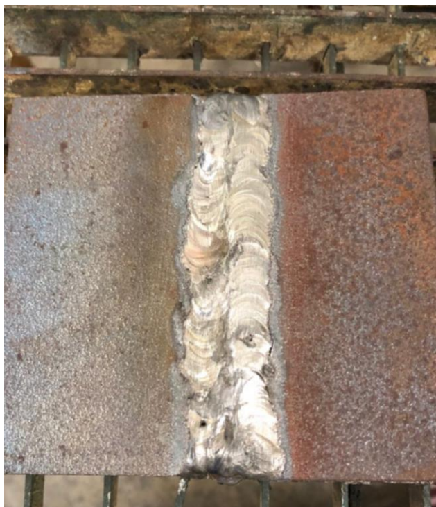
Ilustración 20. Cordón de soldadura terminado sin tratamiento térmico
