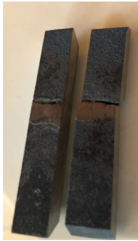
Ilustración 28. Probetas de ensayo de tracción para material con precalentamiento
