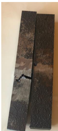
Ilustración 34. Probetas de ensayo de tracción para material sometido a un recocido
