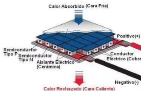
Figura 13: Esquemático de funcionamiento y partes de una celda Peltier.
