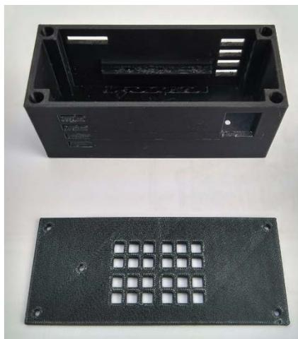
**Figura 31: Ensamble impreso en 3D para el módulo de adquisición.**
