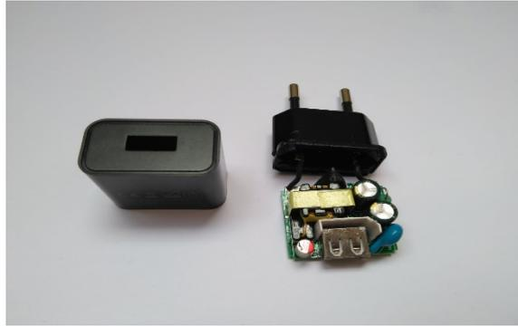
**Figura 26: Fotografía de un cargador de móvil desmontado para la extracción de la fuente de alimentación de su interior.**
