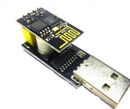
**Figura 27: Convertidor USB-TTL con módulo ESP-01 conectado.**
