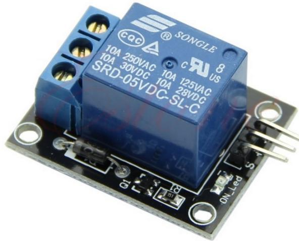
**Figura 36: Relé de corriente continua dispuesto en un integrado con los puertos de conexión.**
