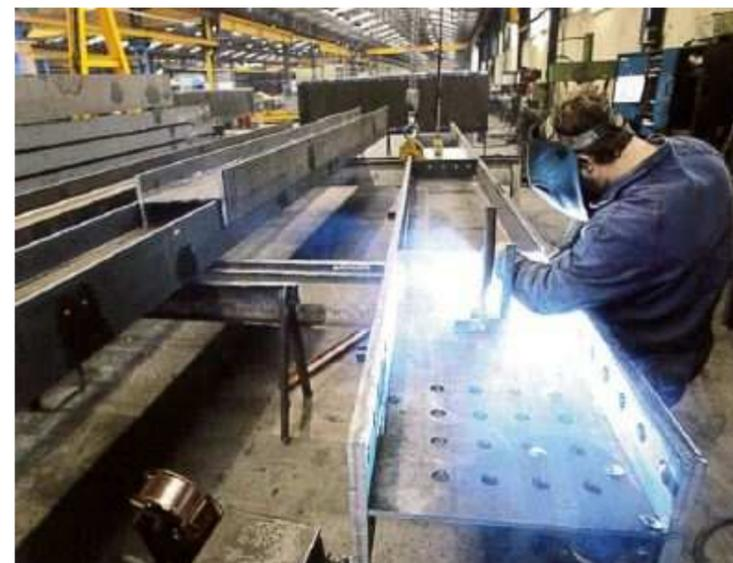
Fig.60. – Fabricación de los pilares y otras piezas metálicas.
