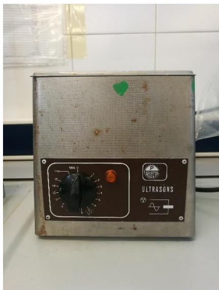
*Figura 5. Baño de ultrasonido, J.P. Selecta Ultrason*
