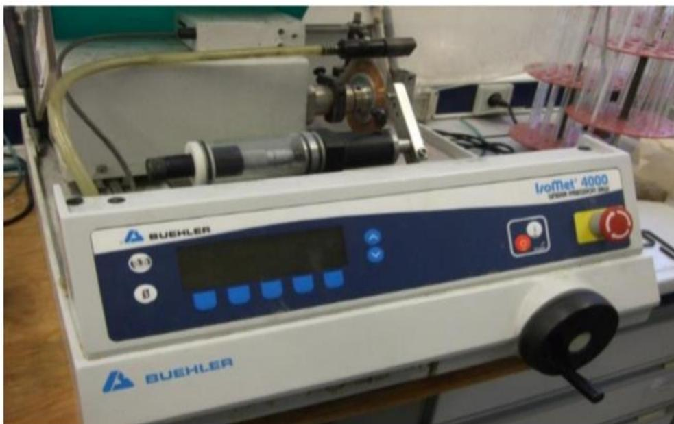
Figura 8. Máquina microcortadora, IsoMet 4000
