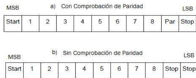
Figura 51. Secuencia de bits en modo RTU con bit de paridad y sin bit de paridad
