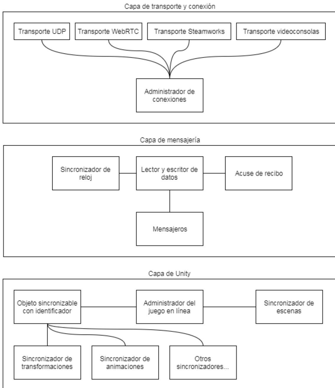
Figura 3 Diagrama básico de la arquitectura por capas del complemento.
