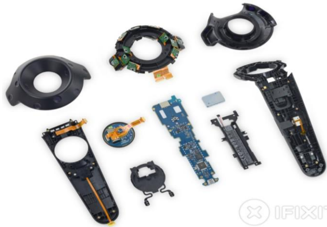
Figura 2-22. Interior HTC Vive Controller 34
