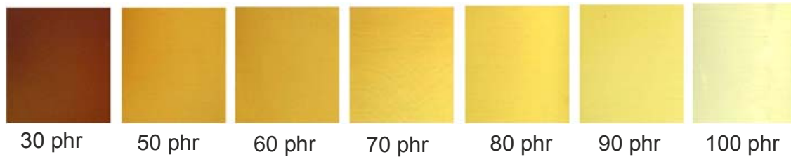
Figura IV.104.- Gráfico de evolución de color de los plastisoles obtenidos con diferentes concentraciones del plastificante tipo I, curados a 220 °C durante 10 min.
