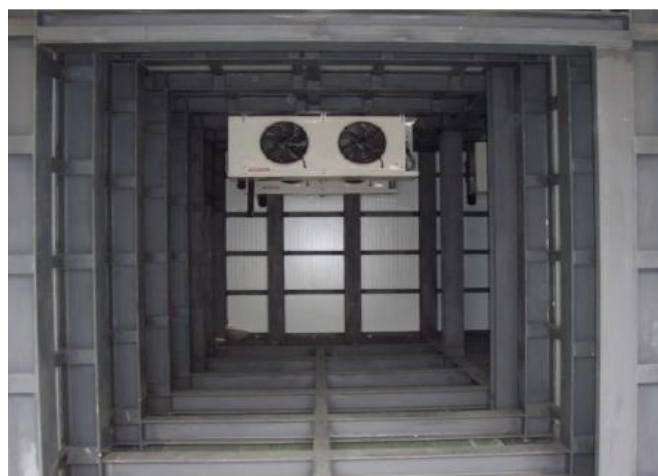
Figura 5. Estructura cámara climática y de altitud
