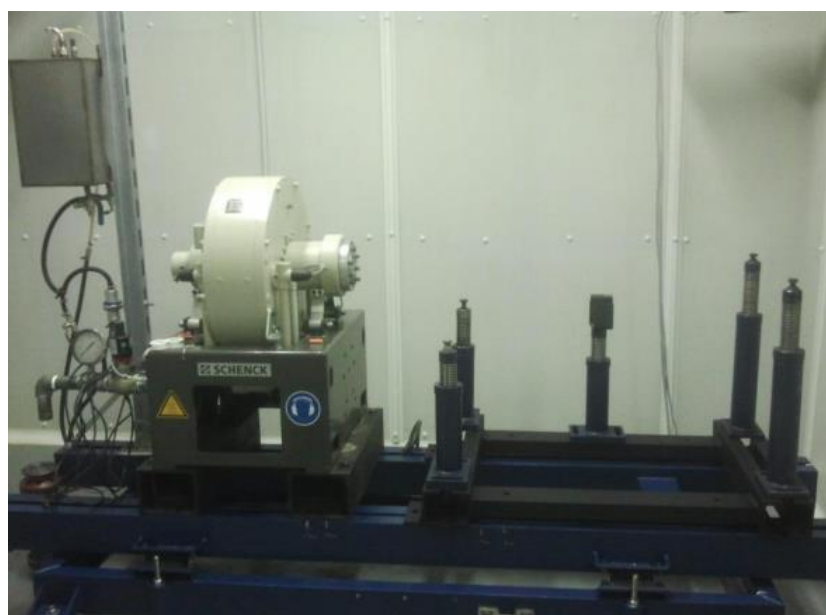
Figura 13. Bancada motor con freno dinamométrico
