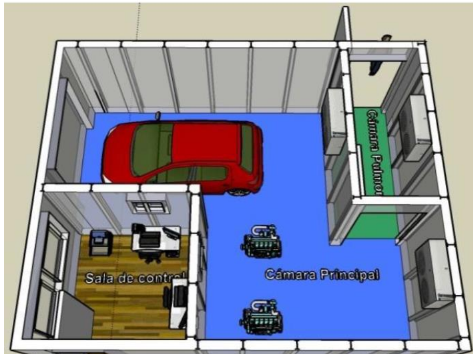
Figura 4. Disposición sala de ensayos
