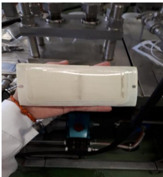
*Figura 3.3. Recorte de la Membrana NF 2540 Duraslick que se utiliza en la planta piloto*
