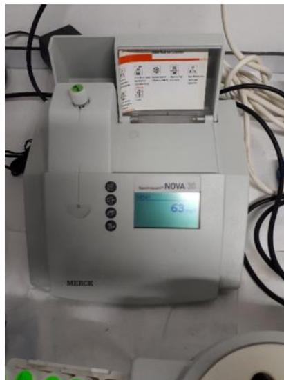
Figura 3.6 Lectura de DQO, espectrofotómetro NOVA.
