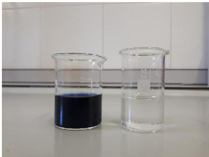
*Figura 4.8 Aspecto de la disolución alimento y permeado tras la finalización de los ensayos.*
