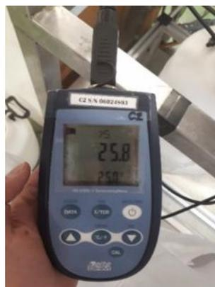
Figura 3.5 Conductímetro (Ela OHM) usado en los ensayos.
