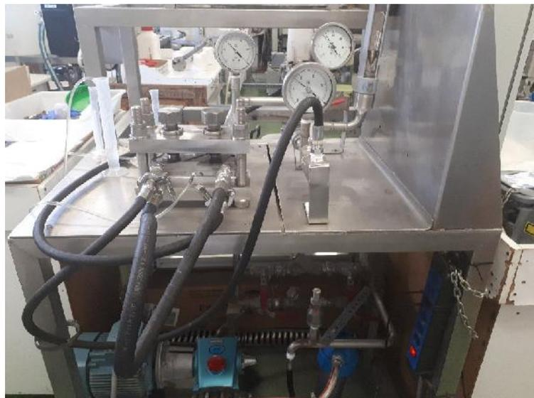
*Figura 3.2 Planta piloto de Nanofiltración.*
