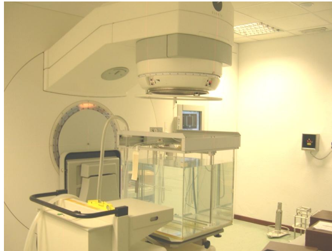
Figura 6.15. Cabezal del acelerador lineal Elekta y la cuba de agua del Hospital Clínic Universitari de València.
