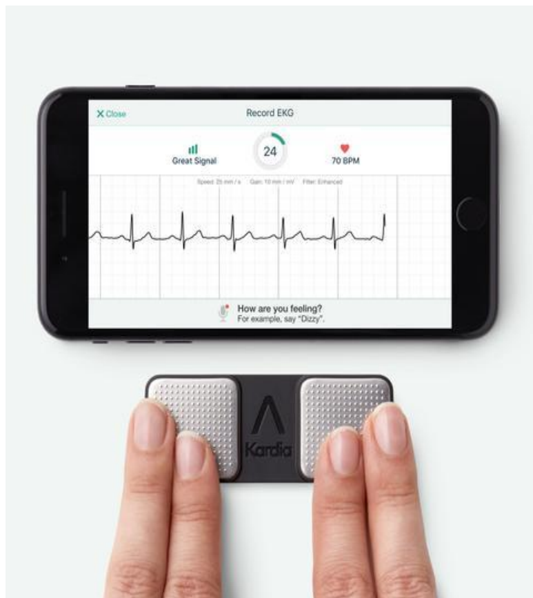
Figura 20. Dispositivo Kardia Mobile™ conectado a la aplicación móvil Kardia App, de la empresa AliveCor, adquiriendo un ECG de una única derivación, equivalente a la derivación I.
