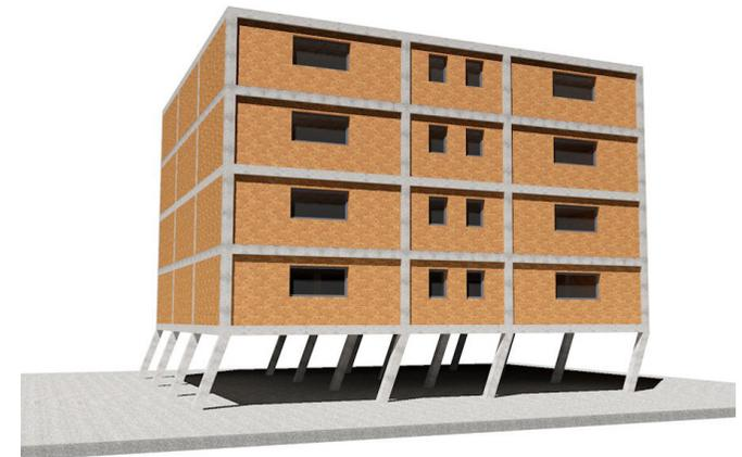
FIGURA 36. Ejemplo edificio con planta libre en respuesta a un esfuerzo sísmico (volumetría)
