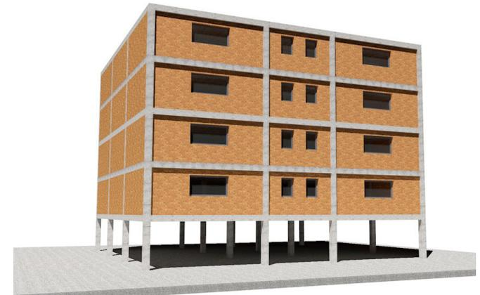
FIGURA 35. Ejemplo edificio con planta libre (volumetría)
