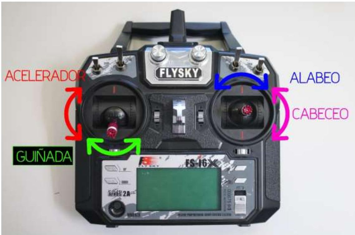
Con el movimiento vertical u horizontal de cada uno de los sticks de la emisora se modifica la señal que recibe el receptor. Estas señales son computadas por la controladora de vuelo e intervienen en el control del dron bimotor tilt rotor como referencias de cabeceo, alabeo y guiñada.
