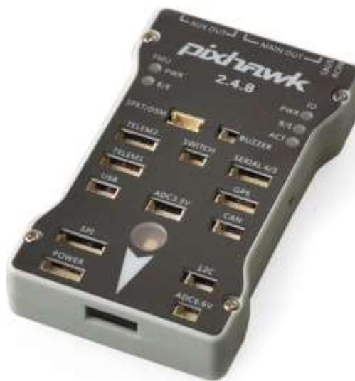
Ilustración 13: Microcontroladora PX4
