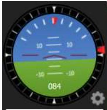
*Ilustración 61: Horizonte artificial o indicador de actitud*
