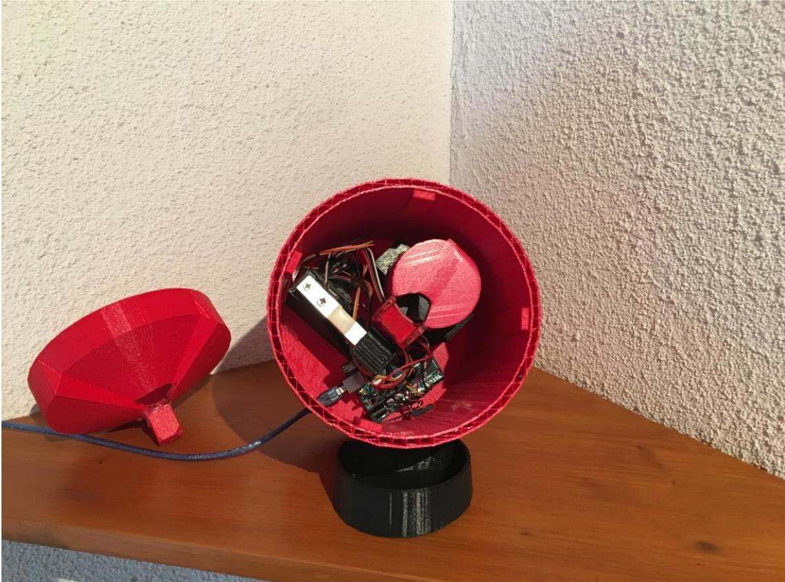
*Ilustración 47 Foto interna dispensador*
