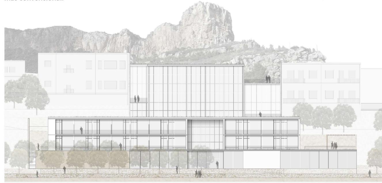
**-Muro cortina:** El muro cortina que se dispone es el modelo S52SGI de la casa STRUGAL. Es un sistema de perfilaría con contratapa, tanto en su trama horizontal como en su trama vertical, esto permite que puedan existir ventanas practicables para favorecer la ventilación. El muro cortina se ancla a la estructura del edificio, más en concreto a los cantos de forjado. El vidrio utilizado es doble con cámara de aire, quedando su composición en 6+6+20+6+6, dejando un espesor total de 44 mm.
