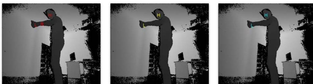
Ilustración 26 – Posición de las distintas articulaciones en un frame con problemas de gestos imposibles. Kinect (izquierda), DepthYOLO (centro), Decision Maker (derecha)
