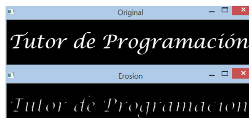
Figura 14. Operación morfológica de erosión
