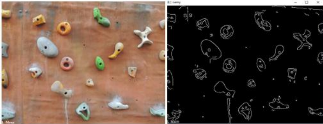
Figura 10. Detección de bordes con fondo uniforme
