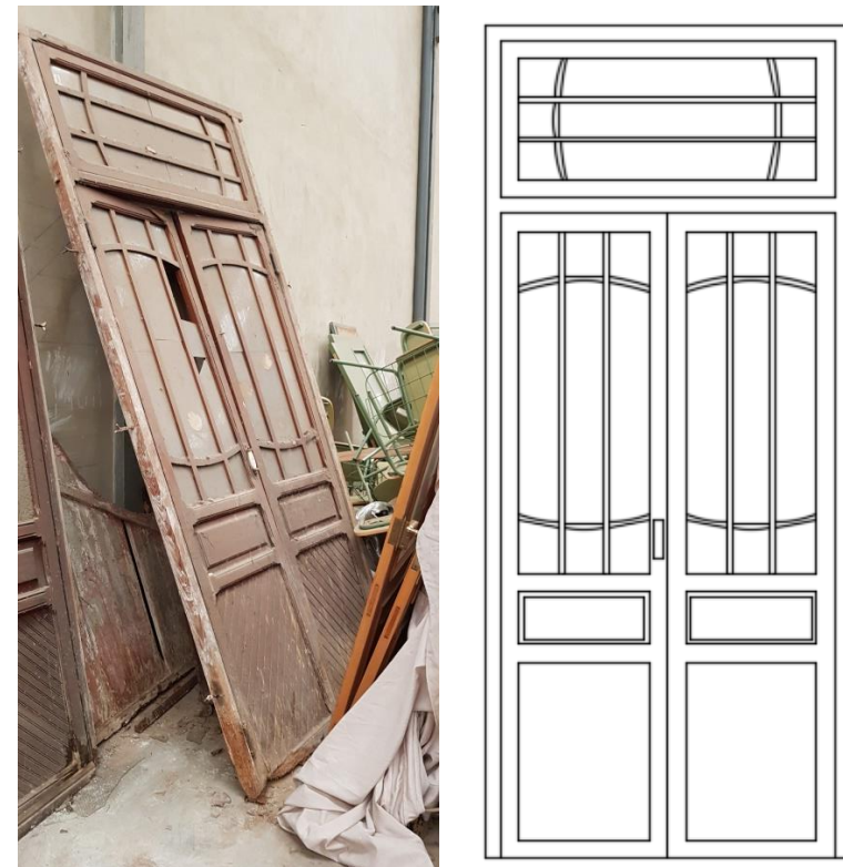
Fig. 48. Fotografía y detalle de la carpintería conservada en el almacén municipal y rejería | Imagen propia. 2018
