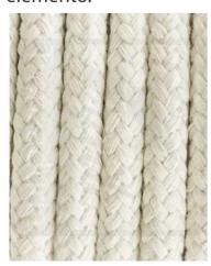
Para sellar este elemento y que no se deshilache se utilizará un quemador textil para las puntas de este. Acercándolo al cordón, calentando la superficie del extremo y apretando un poco el mismo se conseguirá el sellado de una manera eficaz.
