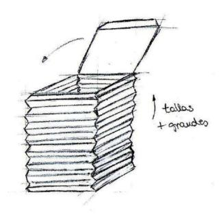
A continuación se muestran unas pruebas, en papel, del pliegue y de su funcionamiento anteriormente explicado. Con este sistema cuando estiremos la pared de la caja para alargar esta estructura también conseguimos que se ensanche de la misma manera para adaptarse perfectamente al tamaño del zapato. De la misma forma, se podría plegar del todo para ser transportado fácilmente y ocupando el menor espacio posible.
