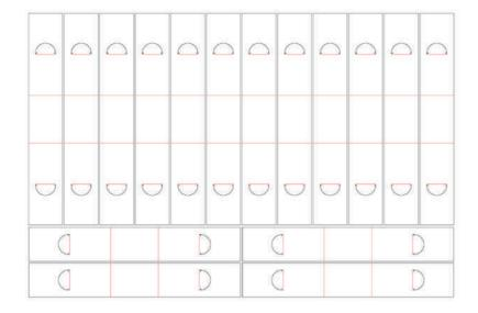
En una plancha de cartón de 962800mm<sup>2</sup> caben 16 partes internas del envase secundario.
