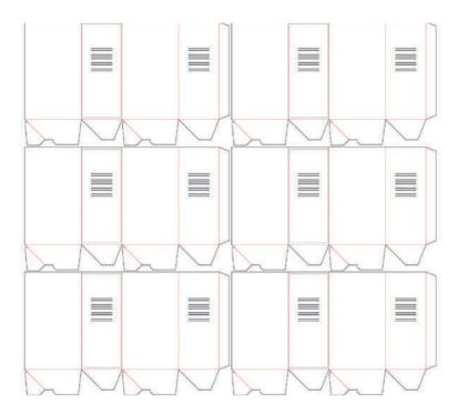
En una plancha de cartón de 962800 mm<sup>2</sup> caben 6 partes externas del envase secundario
