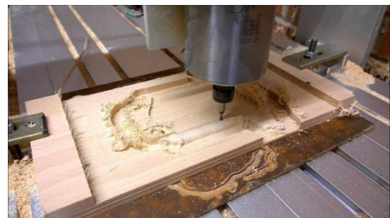
Imagen 65: Proceso de fresado CNC
