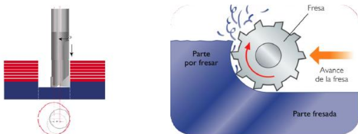
Imagen 67: Trabajo de la fresa
