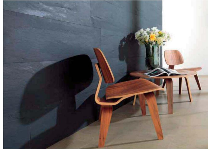
Se utiliza como revestimiento interior **piedra de pizarra natural de bhutan** de la casa comercial Porcelanosa. Este tipo de piedra es Bhutan natural con tono oscuro, creando un juego de tonalidades frente al falso techo metálico y el pavimento de gres porcelánico de acabado en imitación a la madera.
