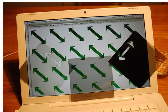
Figura 2.62. Efecto de polarización en una pantalla LCD
