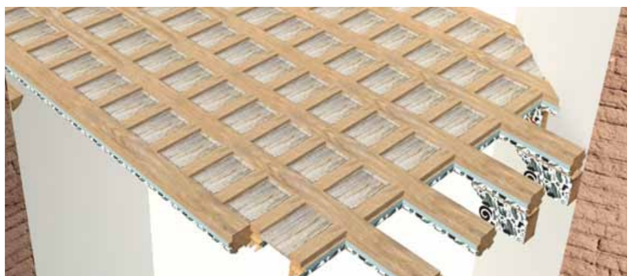
Figura 5:26. Modelo 3D del artesonado del templo de Cusihiuriachi formado por viguetas y peinazos aflechados. (Dibujo: Paulina Grajeda, Arquitectura Cíclica, 2018).
