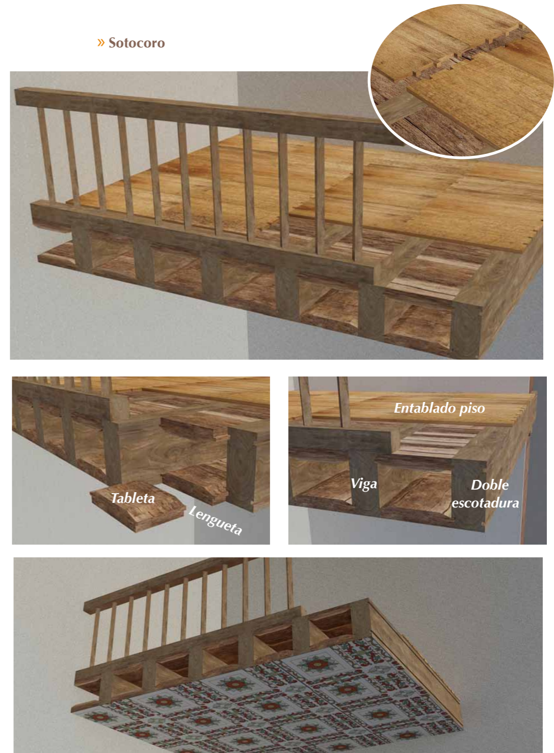
Figura 6:41. Modelo 3D del sistema constructivo del alfarje del sotocoro del templo de Santa María de Cuevas. (Dibujo: P. Grajeda, Arquitectura Cíclica, 2018).
