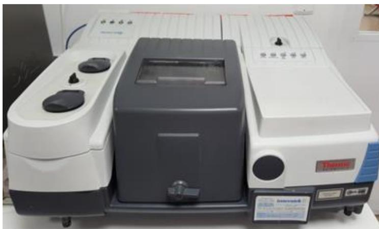
*Figura 31. Equipo NICOLET 6700 utilizado para analizar la estructura química del PP y sus formulaciones de esta tesis.*
