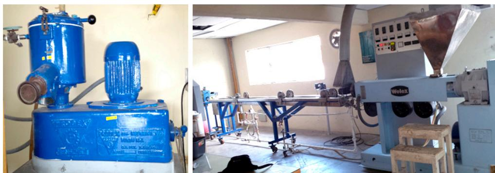
*Figura 50. Molino de aspas y extrusora Welex utilizados en este estudio.*
