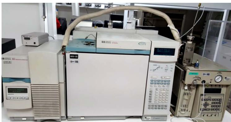
*Figura 34. Imagen del sistema de cromatografía de gases acoplado a un masas y un muestreador de purga-trampa en el que se realizaron intentos de analizar las formulaciones de estudio de PP.*
