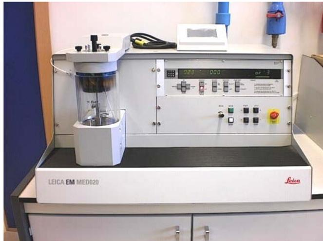
*Figura 43. Sputtering de oro-platino utilizado para metalizar las muestras de PP.
