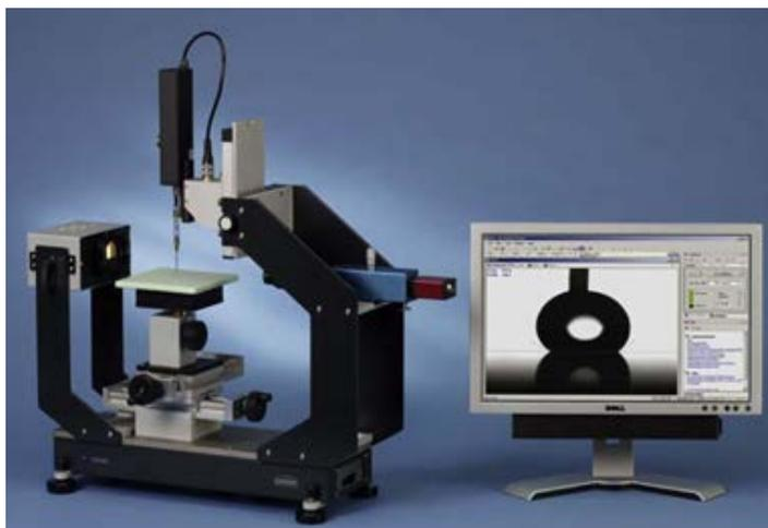
*Figura 41. Goniómetro óptico utilizado para determinar la humectabilidad de las superficies de las diferentes formulaciones de PP.*
