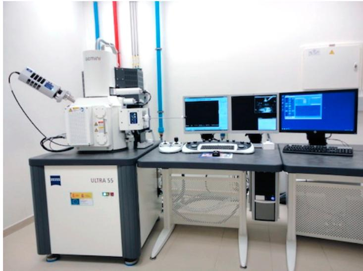
*Figura 44. FESEM utilizado para el análisis de la criofractura de los films de PP.*
