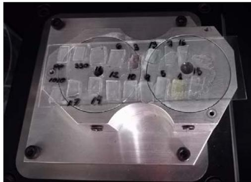
Figura 38. Muestras extraídas de los diferentes films de PP con sus aditivos sobre el portamuestras del nanoindentador G-200.
