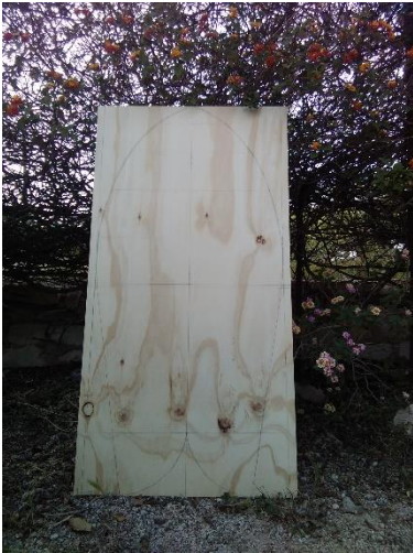
Fig. 57 Contorno de tabla de surf marcado para matriz.
