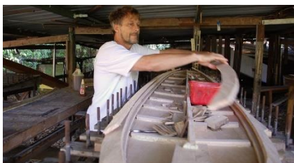
Fig. 11 Tom Wegener trabajando en su taller en la construcción de una tabla de surf de madera, sistema 'hollow-sandwich' .
