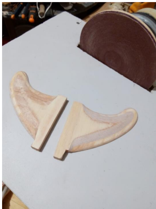
Fig. 72 Proceso creación de quillas.
