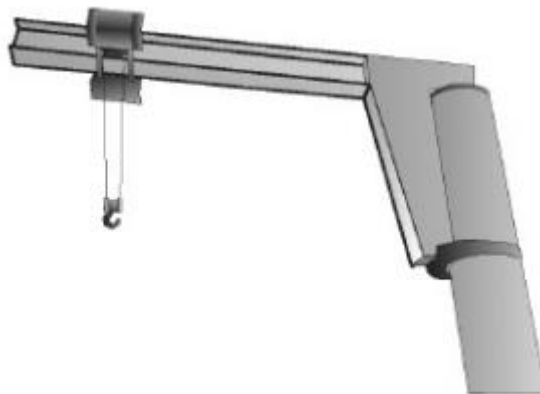
Figura 9. Grúa pluma. Fuente: http://www.insht.es
