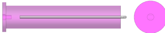
Figura 7 – Detalle del hueco para el eje del motor
