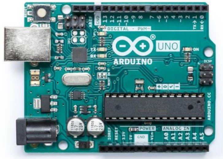
Figura 21 – Disposición pines Arduino UNO
