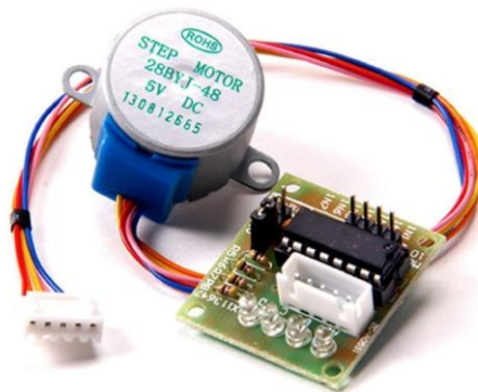
Figura 24 – Motor Stepper 28BYJ-48 y módulo driver UL2003
