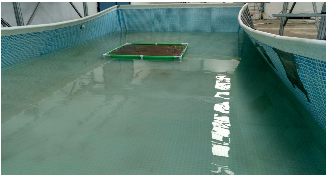
Figura 2.10: Montaje de piscina de plástico y llenado de sedimento.
