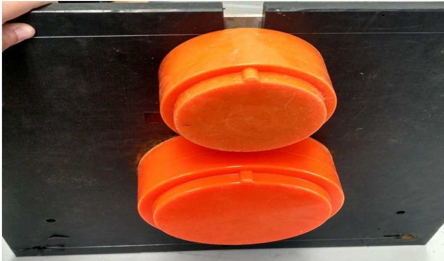
Figura 2.11: Montaje de los transductores bajo la plataforma.
