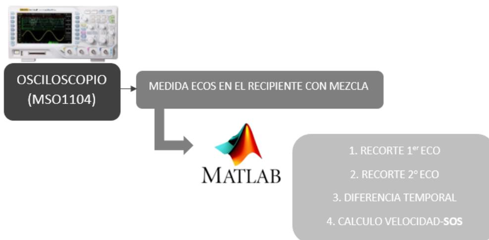
**Figura 3.6:** Diagrama de bloques para la obtención del parámetro SOS.
