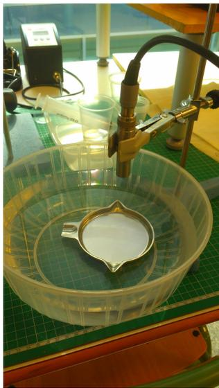
**Figura B.1:** Medida señal de referencia, transductor de 7.5 MHz con placa de metal.
