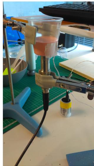
**Figura B.2:** Mezcla en el recipiente para realizar la medida con el transductor de 7.5 MHz.
